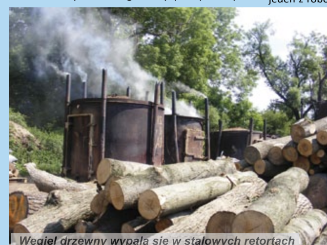
Węgiel drzewny wypala się w stalowych retortach
